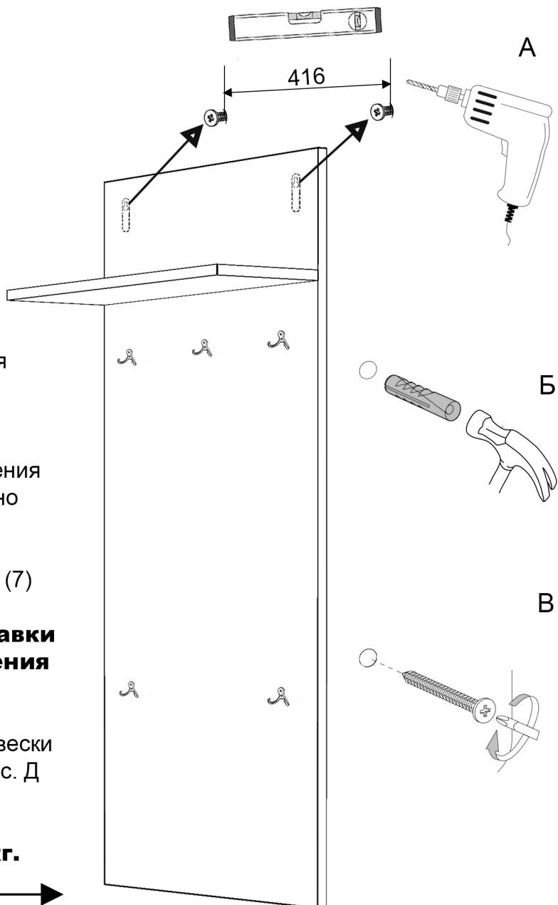
4. С помощью строительного уровня на стене проведите карандашом горизонтальную линию. На ней сделайте разметку, согласно указанному размеру. Высоту крепления вешалки определите самостоятельно по своему желанию. Просверлите отверстия соответствующего диаметра (рис. А), вставьте дюбеля (7) (рис. Б).
