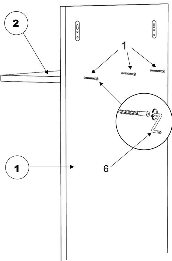
2. Полку (дет. 2) соедините с панелью (дет. 1) с помощью евровинтов (1). Для этого используйте ключ (6), прилагаемый в комплекте.
