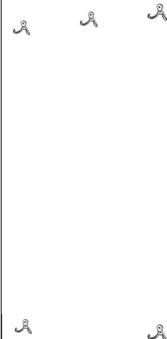
1. Навесы (3) расположите на панели (дет. 1) таким образом, чтобы совпали отверстия на панели и навеске (рис. А). Прикрутите их саморезами (4). Если используете отвертку, то сначала аккуратно шилом проделайте отверстие на месте вкручивания самореза.
