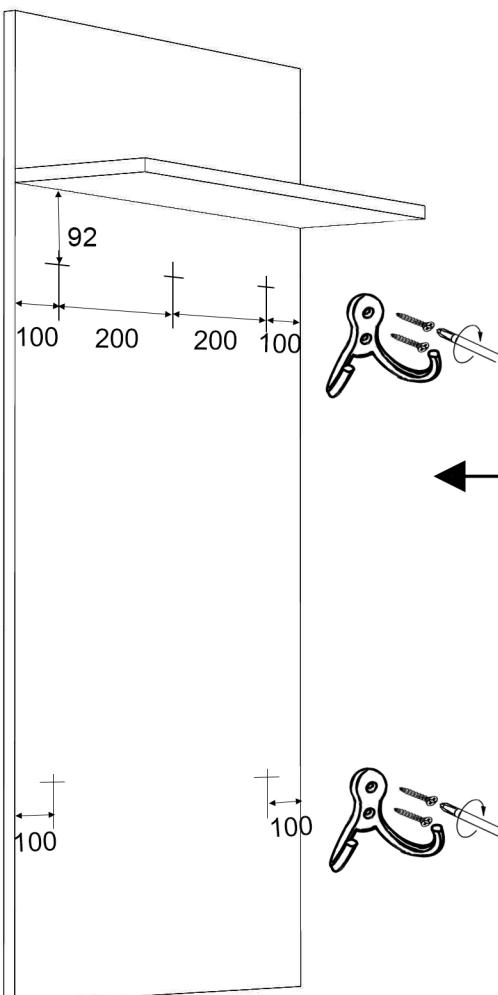
3. Переверните панель, положив ее лицевой частью наверх, сделайте разметку, согласно схеме или по своему желанию, закрепите крючки саморезами (в комплекте). Если используете отвертку, то сначала аккуратно шилом проделайте отверстие на месте вкручивания самореза.
