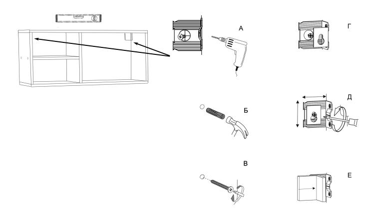
5. К фасаду (дет. 4) прикрутите саморезами петли (4). Если используете отвертку, то сначала аккуратно шилом проделайте отверстие в месте вкручивания самореза. Далее по разметке прикрутите ответную часть петли саморезами (5). Защелкните петлю в ответную планку, согласно схеме А-Б-В. Канавка винта должна войти в паз планки. Закрутите винт. Отрегулируйте фасад согласно схеме. Стрелками указано направление «хода». Соответствующий винт ослабьте, отрегулируйте фасад, затяните винт.
