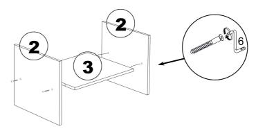
3. Стойки (дет. 2) соедините с горизонтами (дет. 1) с помощью евровинтов (1). Для этого используйте ключ (6), прилагаемый в комплекте.
